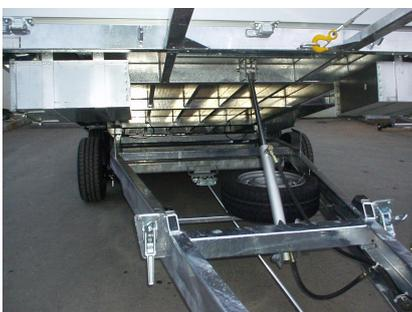
Ersatzrad mit Halterung unter der Ladefläche montiert
